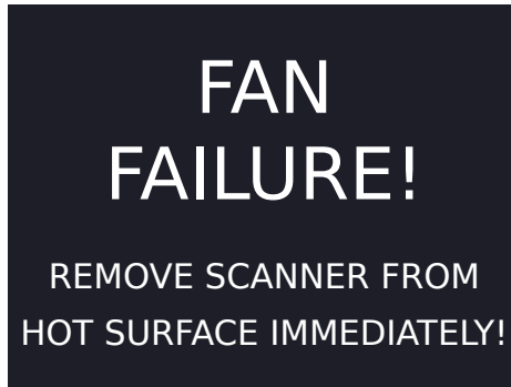
Fig. 23 - Fan failure warning screen
